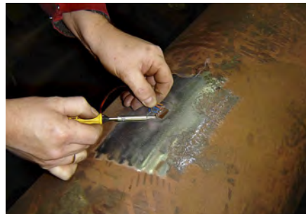
Bild 7: Anbringen eines Dehnmessstreifens auf einer Welle
